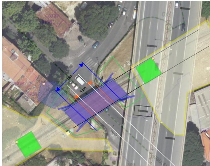
Figure 20 - Principe de phasage de la méthode n°3 – Installations de chantier en jaune (interface plateforme ferroviaire après coupure et dépose des voies ferrées existantes), Blindages provisoires en vert, Emprise de la circulation routière en blanc, Ouvrage neuf en bleu, Grue à tour en vert clair.
