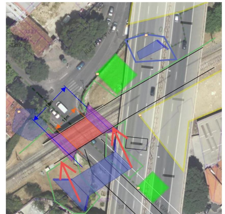
Figure 18 - Principe de phasage de la méthode n°1 – Installations de chantier en jaune, Blindages provisoires en vert, Chicane de la circulation routière en noir, Ouvrage neuf en bleu, Grue mobile en vert clair, Ouvrage existant en rouge (voûte) et violet (culées et murs en aile), ripage de l'ouvrage neuf en flèche rouge.
